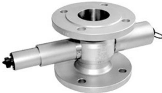
产品概述FP360sc测油仪是一款采用紫外荧光分析法的水中油在线分析仪，灵敏度高。该水中油分析仪可选配耐腐蚀的钛合金探头，不受悬浮颗粒物干扰，提供多种安装方式，可与sc控制器连接。-典型应用FP360sc测油仪是专为监测水中的痕量矿物油而设计的水中油在线分析仪，应用于市政和工业污水，给水处理和工艺水处理（非防爆危险的区域），工业过程监测，海水淡化进水监测，膜处理等。-工作原理FP360sc测油仪基于PAHs的荧光特性，采用紫外荧光法测定水中多环芳烃的浓度。受紫外光激发的PAHs会产生短时间的延迟发光，光的强度会在360nm的波长下测量到，该水中油分析仪通过检测PAH的浓度，计算出水体中油的总含量。-仪器特点□FP360sc
