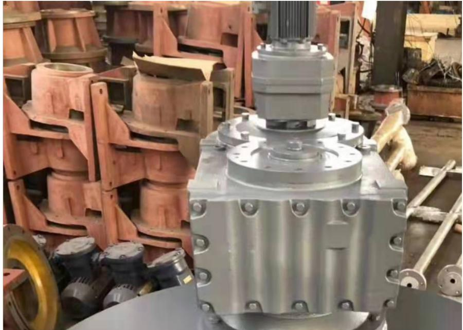
周边传动刮泥机的中心支座由固定支撑座、回转轴承和机架组成，可同时承受轴向力、径向力和倾覆力矩。集电装置采用滑环式集电装置，由集电环和电刷架组成。浮潭刮板、浮渣耙板、浮渣漏斗组成排渣机构，能有效地清理水面浮渣。工作桥是连接中心支座和行走端梁的大型部件，其上有走道板和栏杆，钢梁的下面连接刮泥结构，排渣机构等，在行走装置的带动下来完成刮泥，排渣工作。原水从池底经中心支墩上部流出，并经稳流筒配水后，呈现辐身流向池子周边集水槽出水，随着辐向流速的降低，原水中的悬浮物被分离而降落于池底。工作桥以中心支座为圆心，带动刮泥、排渣机构，在驱动装置驱动下将污泥刮集至沉淀池中心集泥槽，依靠水压或泵排出池外，上部浮渣由刮渣同步刮至排渣斗排出。虹吸刮泥机优点是既不影响水体稳定，动力消耗也较低。无锡单轨刮泥机怎么挑选
